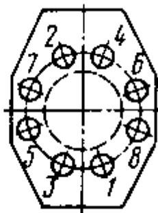
Рисунок 58. Схема затягивания гаек крепления крышки цилиндров
