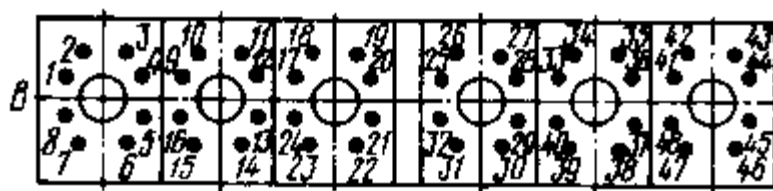
Рисунок 57. Схема нумерации шпилек и гаек крепления цилиндровых крышек; В – сторона привода насосов
